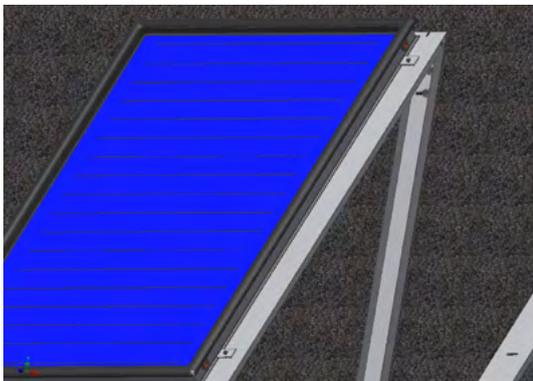
Montieren Sie anschließend auf der nächsten Konsole die Befestigungsplatte „doppelt“ im oberen und unteren Langloch vor. Die endgültige Fixierung erfolgt nach der nächsten Kollektormontage.
