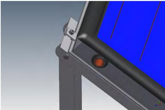
Werden die Konsolen bündig mit den äußeren Kollektoren montiert, dann werden diese abschließend mit den beige-stellten Befestigungsplatten aus dem „Befestigungsset Kollektor auf Konsole Rand“ gesichert. Montieren Sie dazu die Befestigungsplatten am oberen und unteren Ende der Konsole in den vorgesehenen Löchern. Bei Bedarf können die Konsolen bis zu 20 cm vom Kollektorrand eingerückt werden.
