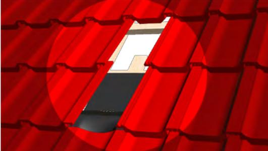
Den ersten Montagelappen so verlegen, dass der untere Ziegel überdeckt wird. Zusätzlich ist darauf zu achten, dass der Montagelappen seitlich unter die nebenstehenden Ziegel geschoben wird (Montagelappen seitlich aufbiegen).
