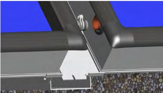
Den nächsten Kollektor an den bereits vorhandenen Kollektor heranschieben. Dabei ist zu beachten, dass die Dehnungskompensatoren ordnungsgemäß bis zum Anschlag in das Kollektorsammelrohr eingeführt werden. Fixieren Sie den hydraulischen Verbinder mit der Sicherungsfeder.
