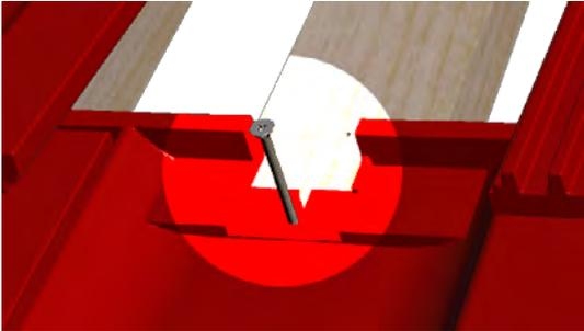
Neben dem Schroten des Dachziegels wird empfohlen, eine in die Ziegelhakenauflage eingebrachte Schraube als Auflage zu nutzen.
