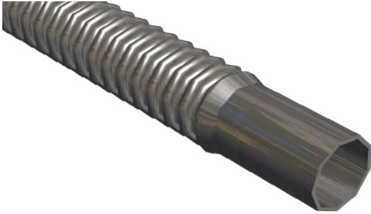
Die Anschlussleitung kann individuell angepasst werden. Dazu wird das Edelstahl-Wellrohr auf die entsprechende Länge geschnitten. Verwenden Sie dazu einen Rohrschneider. Prüfen Sie die Rohrenden auf Verunreinigungen, Verformungen und Gratfreiheit.
