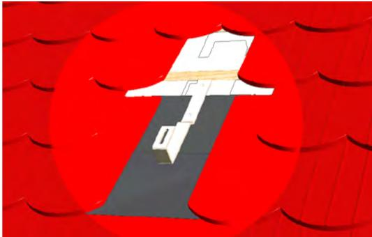
Befestigung des Ziegelhakens mit den zwei Schrauben 5x60 mm.
