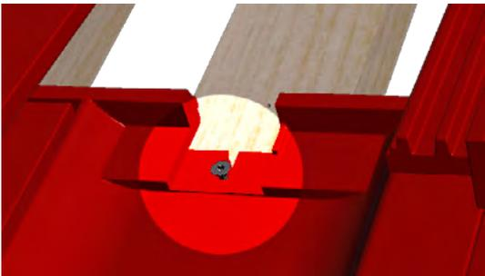
Fertig montierte Schraube als Abstandshalter.
