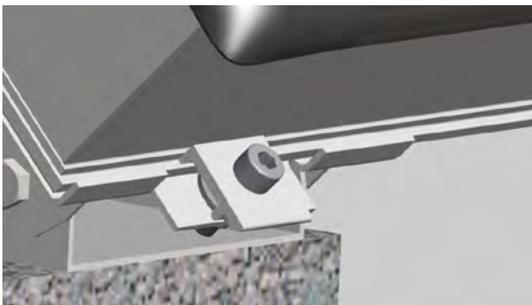
Die Befestigungsplatte am unteren Ende der Konsole muss mit der breiten Seite in den Kollektorrahmen eingehangen werden.
