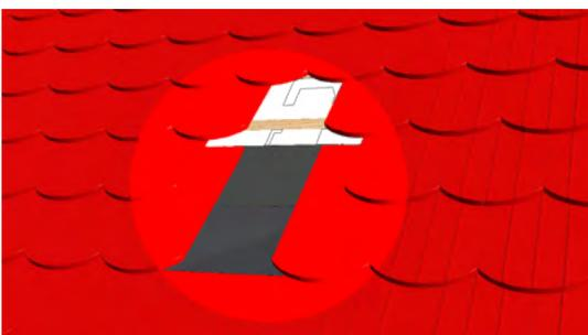
Montage des unteren Bleilappens. Das Blei wird dabei seitlich unter die Ziegel verlegt.
