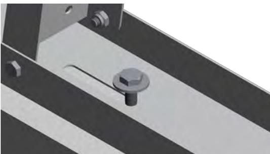
Platzieren Sie anschließend die Bodenkonsolen auf den Betonsockeln und befestigen Sie diese mit den beigefügten Schrauben M10. Alle weiteren Konsolen müssen exakt in einer Reihe ausgerichtet sein (z. B. Schnurschlag)
