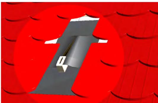
Montage des oberen Bleilappens. Das Blei wird seitlich unter die Ziegel verlegt.
