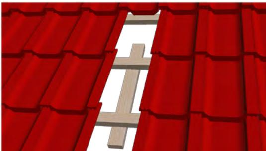
Befestigen der untenliegenden Latte  $24 \times 80 \times 600 \text{ mm}$  mit zwei Schrauben  $4 \times 50 \text{ mm}$ .
