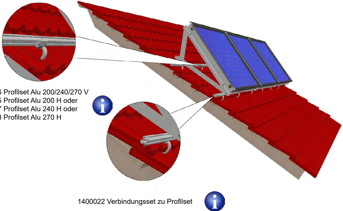
Bei Aufdachanlagen werden Profilsets in Abhängigkeit zum Kollektortyp geliefert. Werden mehrere Kollektoren in einer Reihe verbaut, wird für jeden Kollektorübergang ein Verbindungsset erforderlich.
